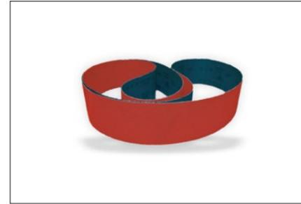
Dieses Schleifband mit Keramischem Korund verfügt zusätzlich über einen kühlenden Deckbinder (Topsize) und ist damit auch zur abtragsstarken Bearbeitung sehr harter Stähle geeignet. Auch hohem Anpressdruck hält die hochstabile Polyesterunterlage problemlos stand.
