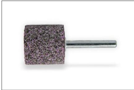
Unser SPEEDEXFLEX® Schleifstift Mischkorund mit keramischer Bindung wurde speziell für Gussmaterial optimiert. Typische Anwendungen sind das Putzen und Entgraten von Werkstücken und das Ausschleifen von Lunkern.
